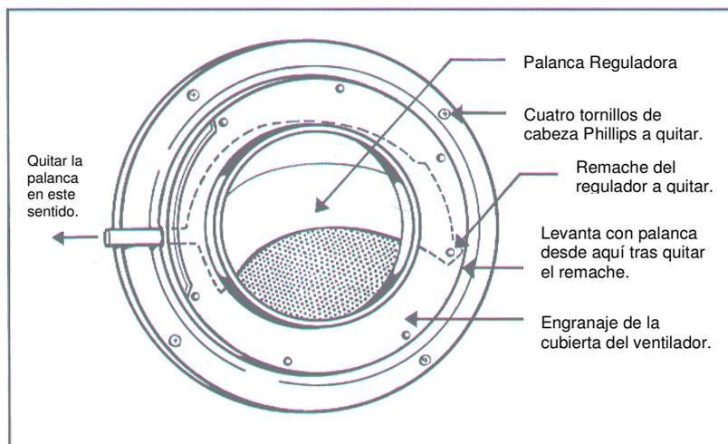
Hay siete remaches sujetando la cubierta de plástico del regulador a la cubierta metálica del ventilador. Localiza el que también actúa como pivote de la palanca y quítalo usando un clavo y un espaciador (mirar ilustración).
