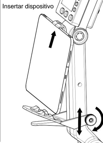
Aloja el pomo roscado para deslizar el soporte inferior hacia arriba o hacia abajo. **Importante:** Aprieta el pomo roscado cuando el dispositivo esté colocado.
