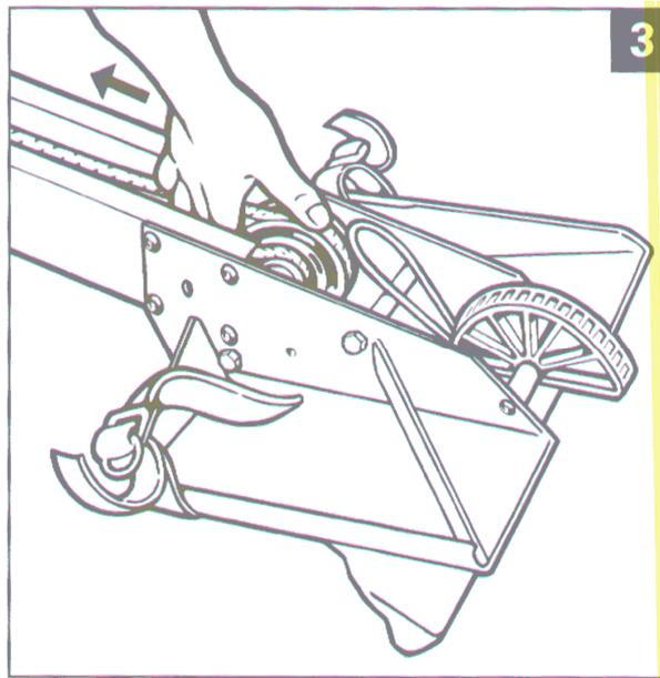
4. Quita la pieza de bloqueo, suelta los tornillos de llave Allen usando la 4mm.
