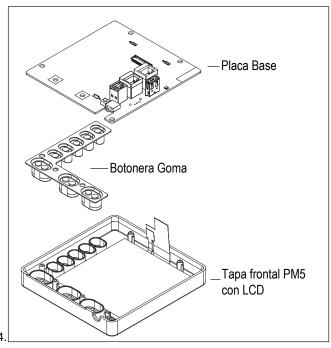
Invertir el proceso de desmontaje para instalar la tapa frontal/LCD.
