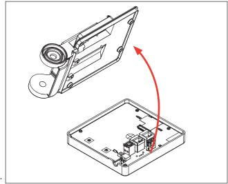
Separar cuidadosamente la tapa trasera de la tapa delantera, observando la posición de los contactos metálicos de las pilas.
