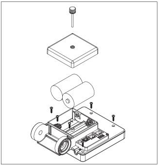
Desenchufar los cables y separar el PM5 de la máquina. Quitar la tapa de las pilas y sacarlas. Quitar los 4 tornillos exteriores y los 2 interiores de la tapa trasera del PM5.
