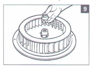
Invierte los pasos 1-4 para volver a poner la tapa del ventilador. Mientras sujetas la tapa del ventilador cerca de la rejilla perforada (pero no en) coloca los cuatro tornillos en las tuercas agujero en "U", después empuja la tapa y aprieta totalmente (mirar abajo).
