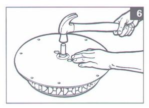
6. Saca el soporte del rodamiento utilizando el punzón.
